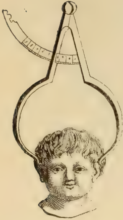
FIG. 1110. — Céphalomètre de Stein.
